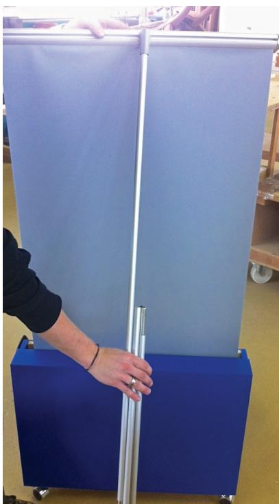
Den Aufnehmer von hinten in das obere Aluprofil einstecken und das Gestänge anschliessend ganz aufklappen und zusammenstecken.
